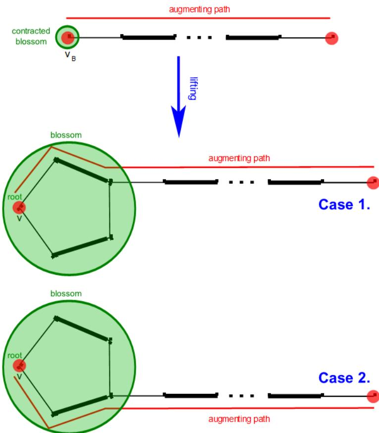
继续观察可以发现，整个奇环的匹配状态只与顶点的匹配状态有关，如果在后来的某一次寻找时奇环上的匹配被改变了，那么顶点的颜色唯一决定了整个环的匹配边是如何走的。（花上的任意一个点都可作为0型点出边）
